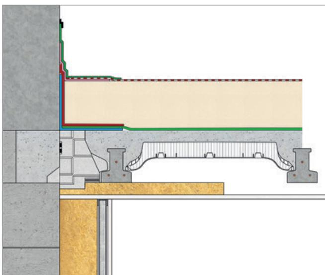
Le système TERRAWATT évite la pose d'un pare-vapeur en sous-face, supprimant ainsi les risques liés à une mauvaise mise en œuvre de ce dernier.
