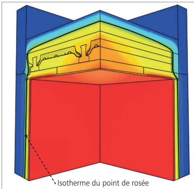
En plaçant la totalité de l'isolant au-dessus du plancher, le système TERRAWATT vous garantit une parfaite maîtrise du point de rosée quelque soit votre projet.
